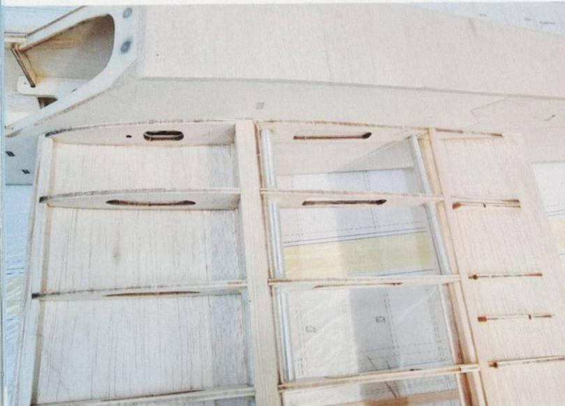
Die Steckung wird überprüft, indem alles einmal zusammen gesteckt wird, ohne es zu verkleben.
