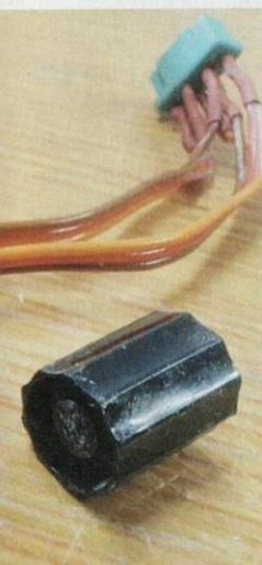
Die Rändelschraube besteht aus M5-Nylonschraube und einem abgeschnittenen Kopf einer Uhuhart-Tube.
