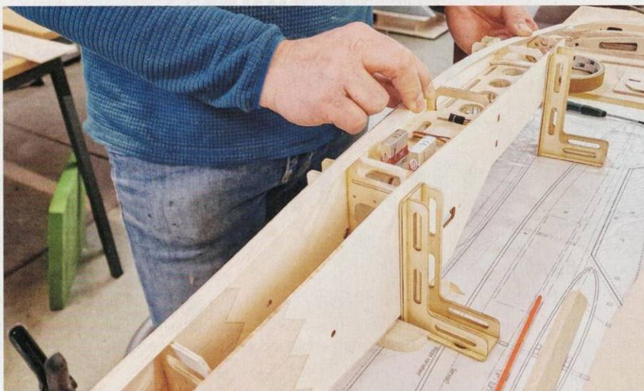
Mit dem Rumpf in Rückenlage werden die unteren Leisten eingelegt und verklebt.
