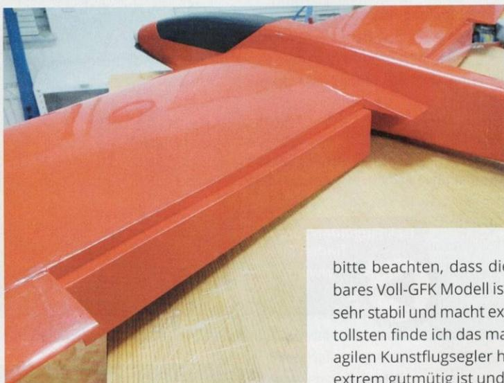
Das Querruder wird oben angeschlagen, die Wölbklappen unten, um vollen Ausschlag nach unten zu ermöglichen.
