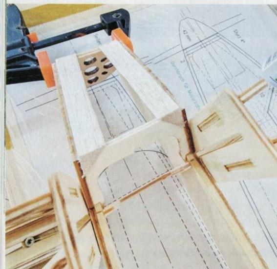
Motorspant und Leisten werden unter Berücksichtigung des Motor-Zuges eingeklebt.
