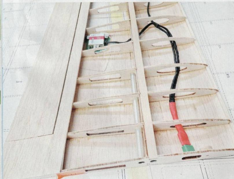
Die Verstärkung 22 für die Flächenschraube wird einmal an die Rippe R1 geklebt und später auch in den Rumpf.
