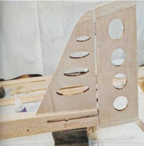
Das Seitenruder wird mit Scharnieren angeschlagen – auch Vlies-Scharniere sind geeignet.
