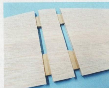
Wahlweise kann das Leitwerk geteilt und steckbar ausgeführt werden.
