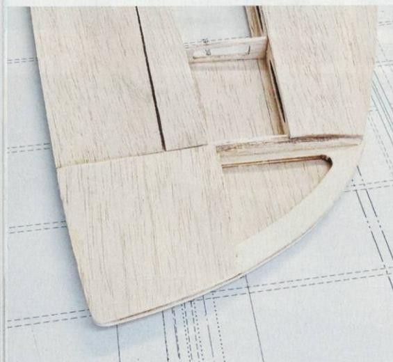
Der Randbogen wird mit F5 verstärkt und später beplankt.
