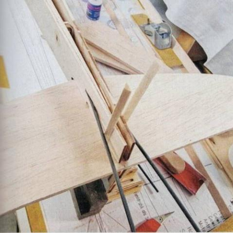
Die Bowdenzüge werden in den Rumpf eingezogen, bevor er verschlossen wird.
