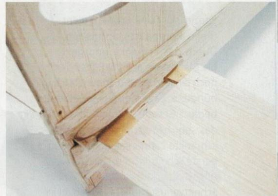
Die steckbare Ausführung des Leitwerks – gesichert wird es mit kleinen Holzschrauben von unten.
