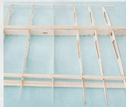
Die Hilfsholme sind aufgrund der geringeren Bauhöhe aus dünneren Kiefernleisten.
