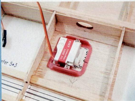
Ist die untere Beplankung vorn und hinten verklebt, schließen wir das Rippenfeld zwischen R8 und R9 und positionieren auf der Beplankung das KST-Servo mit dem Montagerahmen. Geklebt wird der Montagerahmen mit UHU Endfest.
