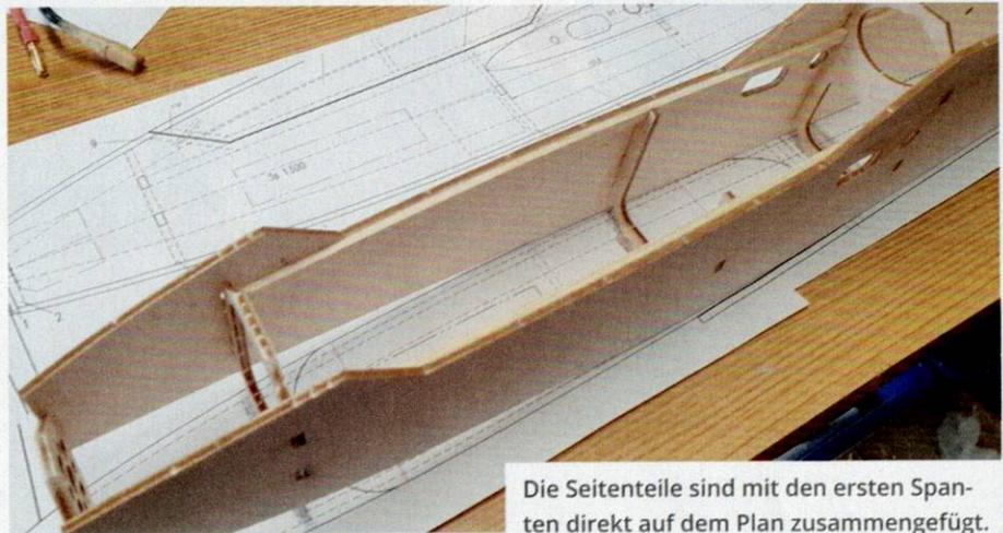
Die Seitenteile sind mit den ersten Spanten direkt auf dem Plan zusammengefügt.
