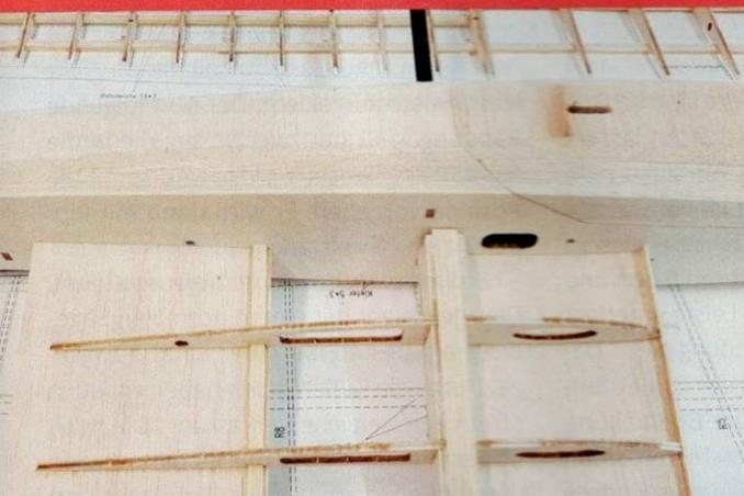
Die untere Flächenbepunktung wird an den Rumpfverlauf angepasst. Die Steckungshüllrohre sind dazu bereits in Rumpf und Fläche verklebt.
