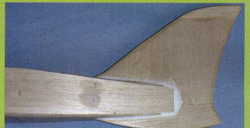
Die Übergänge zum Leitwerk werden mit Spackelmasse angeglichen.
