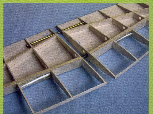
Ein Blick auf die Flächensteckung zeigt die Verkastung von Haupt- und Hilfsholm.
