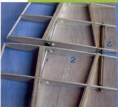
Ein Blick auf die Flächensteckung zeigt die Verkastung von Haupt- und Hilfsholm.
