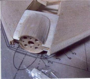
Anbringen der Verkleidungen am Motorspant.
